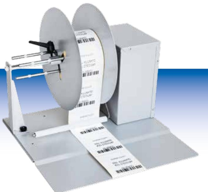
Die Vorrichtungen sind mit verschiedenen Breiten von 130 mm oder 230 mm erhältlich. Der Spreizdorn ermöglicht die Verwendung von Rollenkernen von 40 bis 110 mm und das Aufrollen von Rollen bis zu einem Außendurchmesser von 300 mm.
