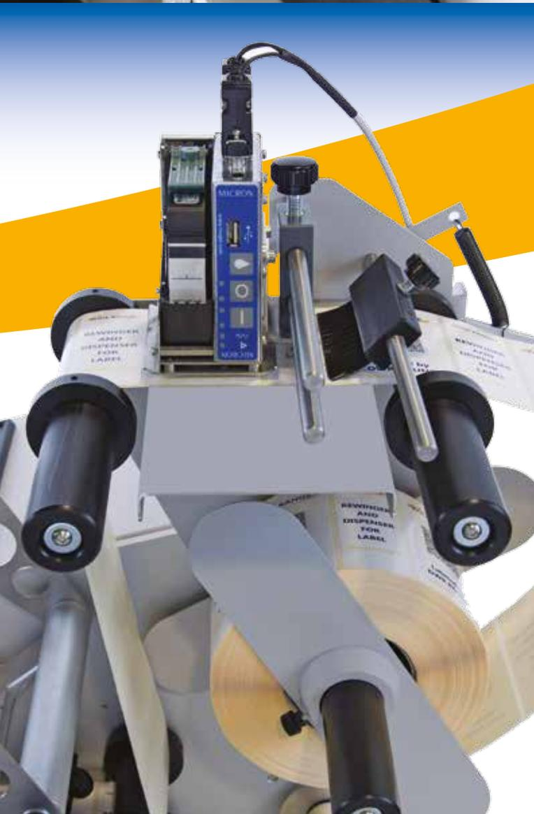
Die DWR ROUND kann mit einem Tintenstrahlmarkierer mit HP-Technologie zum Schreiben verschiedener Daten wie Uhrzeit, Barcode, Texte mit einer maximalen Höhe von 12,7 mm und einer Auflösung von 300 dpi und einer mit dem Vorschub der Etikette synchronisierten Geschwindigkeit ausgestattet werden. Der mit einer zugehörigen Software auf einem PC vorbereitete Text wird mit einem USB-Stick auf den Markierer übertragen.
