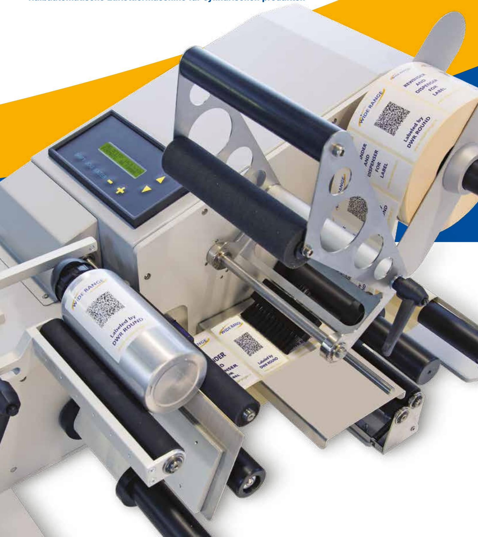
Die DWR ROUND ist eine halbautomatische Etikettiermaschine für die Anbringung von Selbstklebeetiketten auf zylindrischen Produkten. Sie ist in einer Version mit einer maximalen Breite von 200 Millimetern erhältlich, mit einem Spulenhalter, der Spulen mit einem maximalen Durchmesser von 300 Millimetern aufnehmen kann und somit eine große Arbeitsautonomie gewährleistet.
