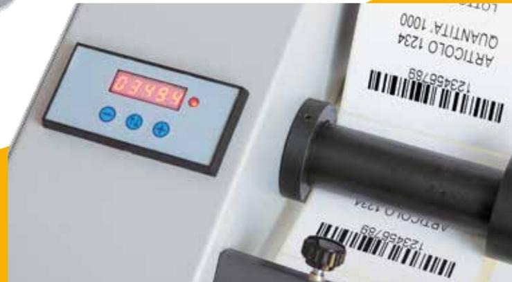
Die Verwendung der Version mit Akku ermöglicht abhängig von der Größe der Etikette und der Entnahmehäufigkeit einen circa 5-stündigen Betrieb ohne elektrische Versorgung.
